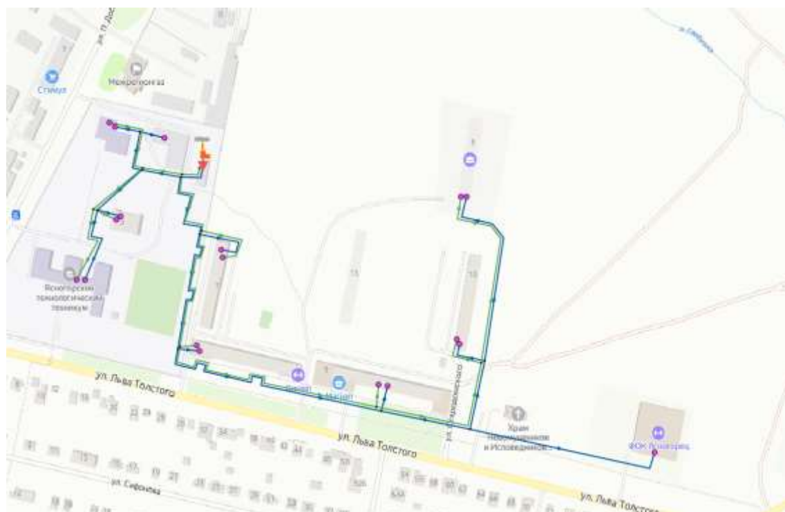
Рисунок 3.3.6 – Электронная модель системы теплоснабжения от котельной Детский сад №7
