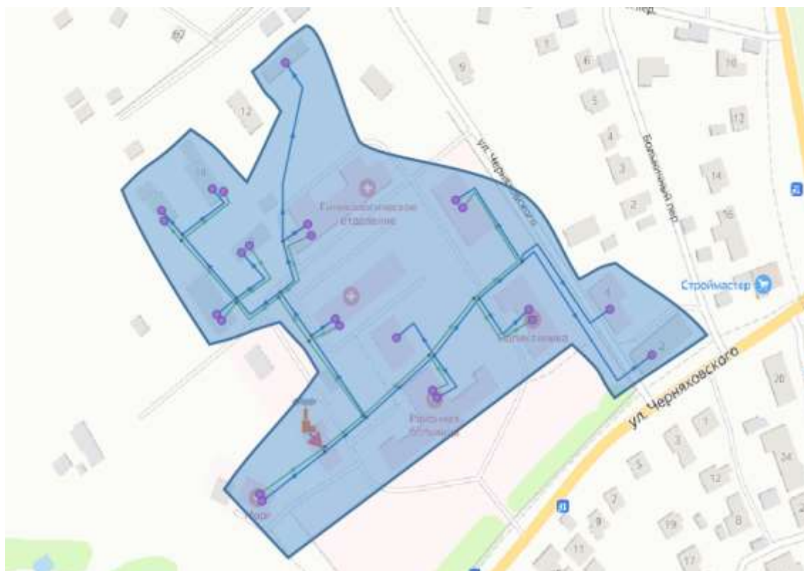
Рисунок 1.4.4 – Зона действия котельной ЦРБ
