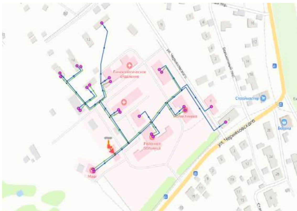
Рисунок 3.3.8 – Электронная модель системы теплоснабжения от котельной ЦРБ
